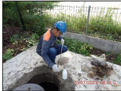
บ่อฟักน้ำเสียหลังผ่านระบบบำบัดน้ำเสียส่วนกลาง
